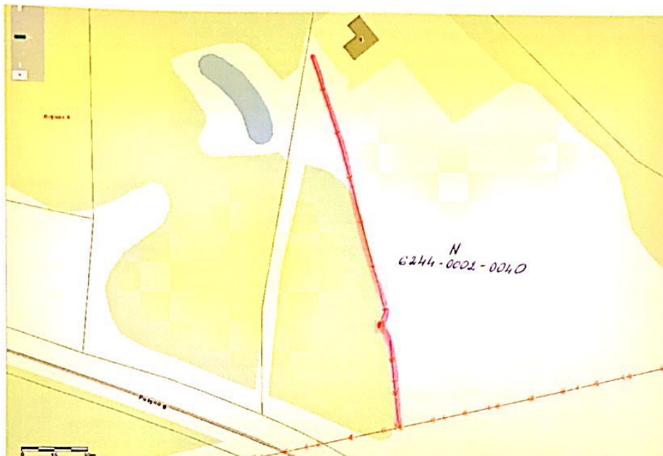
6. Elektros tiekimo linijos: 940 m ilgio 10 kV laidais 3xAs-35 ant 13 vnt. g/b atramų; 620 m ilgio 0,4 kV laidais 4xA-50 ant 18 vnt. g/b atramų; komplektinė transformatorinė su transformatoriumi KT-A-337 100 kVA (unikalus numeris 6299-2009-3013), Molėtų r. sav., Alantos sen., Gaidamonių k.
